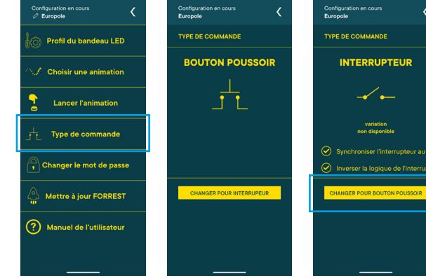
Cliquer sur « Type de commande ». Le mode bouton poussoir est sélectionné par défaut. Maintenir le bouton poussoir fait varier l'intensité lumineuse.
