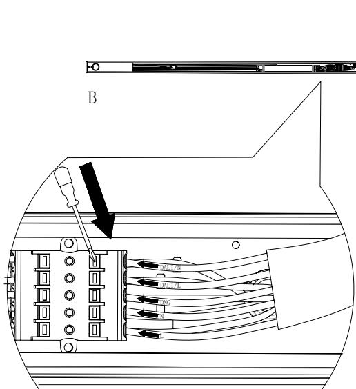
Schéma de câblage et fonctionnement variation DALI/PUSH DIM
