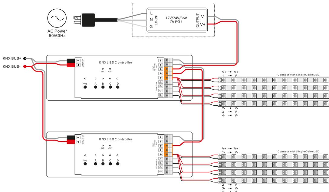
Les luminaires LED peuvent être commutés (ON/OFF), atténués, rappeler la scène ou d'autres opérations via le bus.
