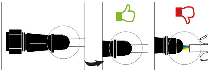
S'assurer que la gaine est bien prise, qu'il n'y a pas de câble visible lorsqu'une légère traction est réalisée sur la gaine.
